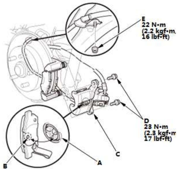
1. 将活塞的切口 (A) 对准内制动片上的凸舌 (B)。
