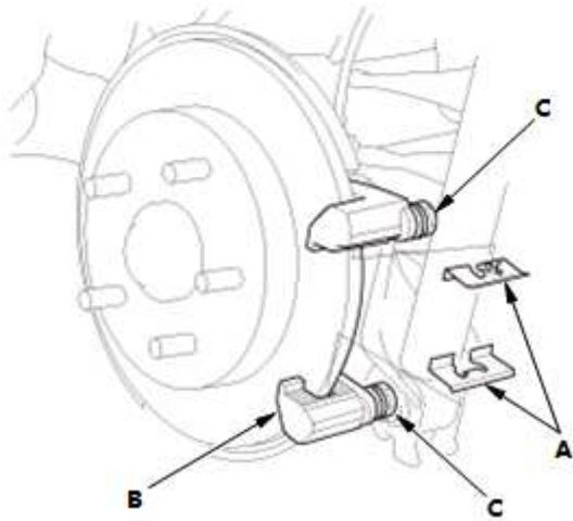
1. 拆下制动片夹持器 (A)。
