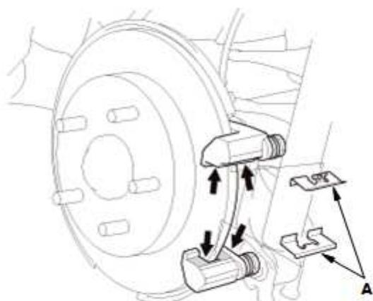
1. 将钼化物 M-77 润滑脂涂抹在夹持器与制动钳托架的接合面（箭头所示）上。
