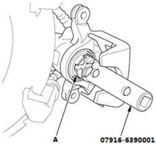
注意：将活塞移回制动钳中时，小心制动液可能从总泵储液罐中溢出。如果制动液接触到油漆表面，立刻用水清洗干净。
